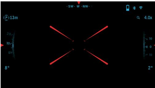
Um die Entfernung zu einem Ziel mit dem Laser-Entfernungsmesser zu messen, drücken Sie kurz die POWER-Taste. Der Entfernungsmesser führt mehrere Messungen durch und zeigt die Entfernung in der oberen linken Ecke an. Das Gerät verlässt den Messmodus automatisch.
